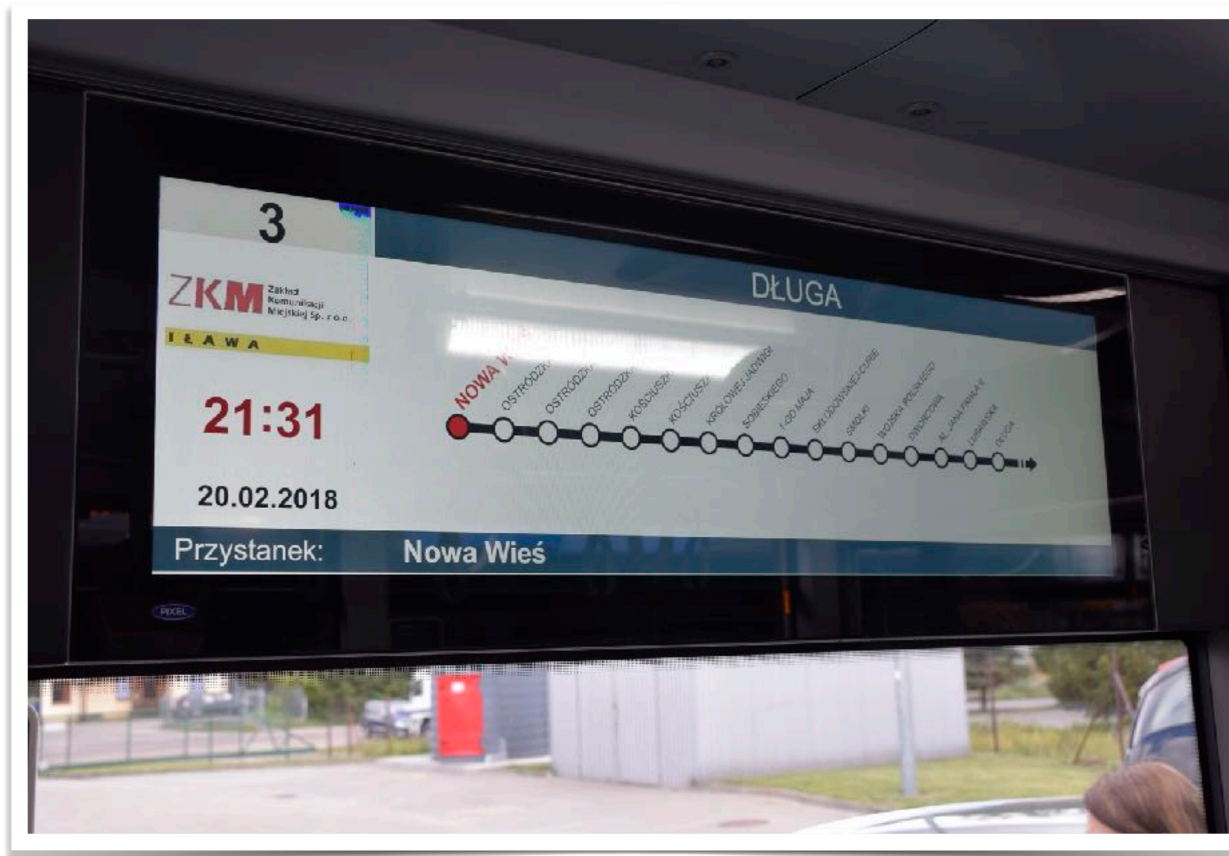
System dynamicznej informacji pasażerskiej
