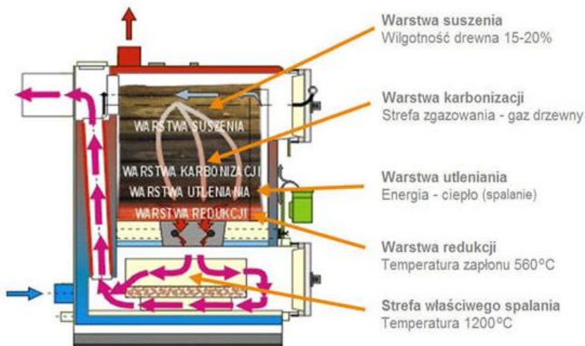
Ryc. 21. Schemat spalania drewna w kotle zgazowującym
