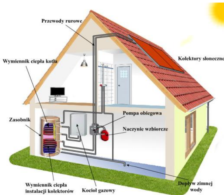
Ryc. 16. Schemat instalacji kolektorów słonecznych w domu jednorodzinnym
