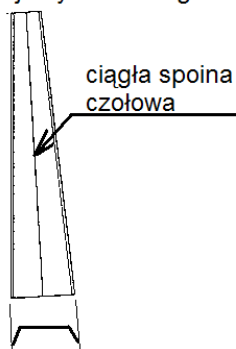
Rys. 8. Pale specjalne wykorzystywane do zniwelowania pochylenia ścianki
